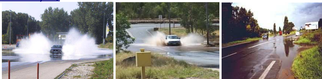
Rys. 4. Przykłady bardzo złego projektowania niwelety
